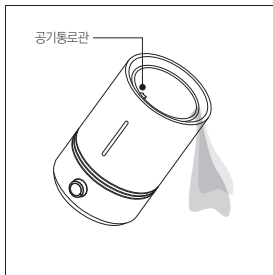
본체 오른쪽 방향으로 버려 주십시오. (본체 안쪽에 고정된 공기통로관에 물이 들어가지 않도록 주의해 주십시오.)
